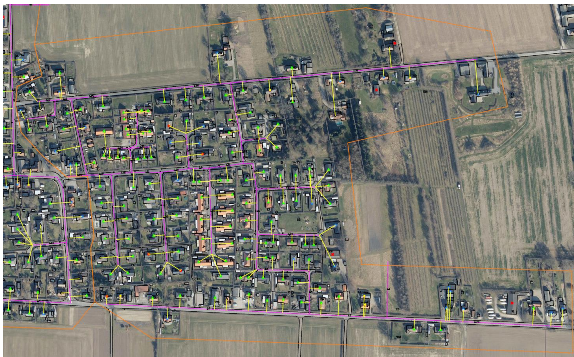
Figur 4: Udstrækning af ledninger i område 4
